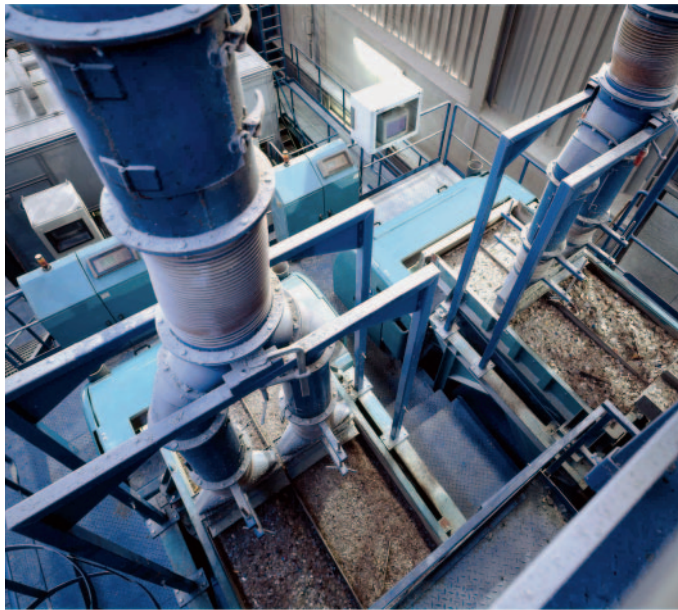
Bild 5: Aufgaben von vier Fraktionen auf zwei Mogensen MikroSort nach Klassierung mit einem Mogensen Sizer SC1046
