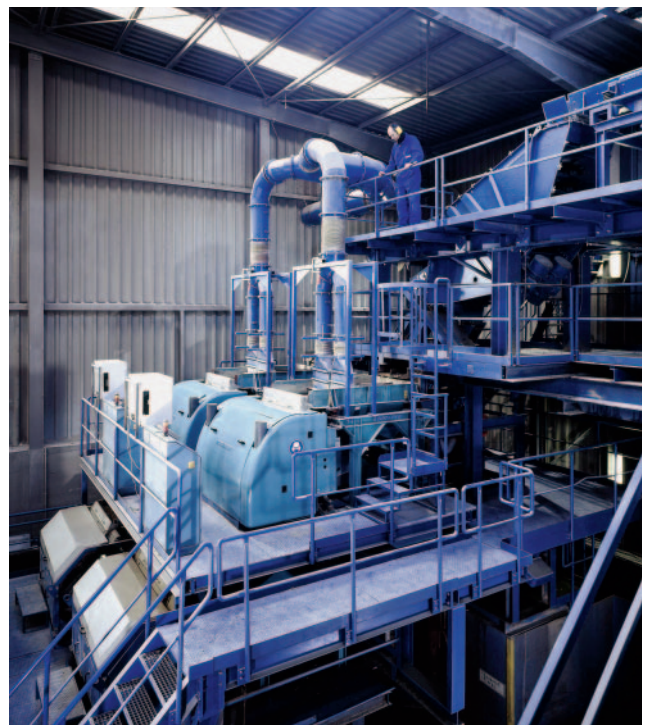
Bild 4: Aufbereitung von Recyclingglas 5–60 mm Fig. 4: Processing of recycled glass 5–60 mm
