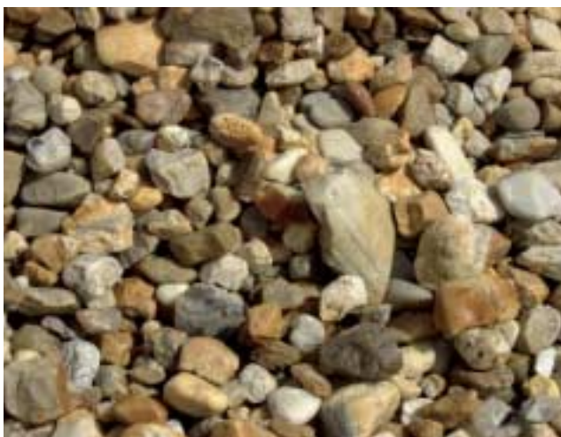
Bild 3: Abweismaterial: Quarz mit niedrigem Eisengehalt
