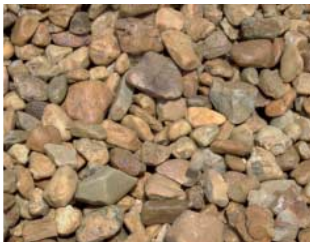
Bild 4: Durchgangsmaterial: Quarz mit hohem Eisengehalt
