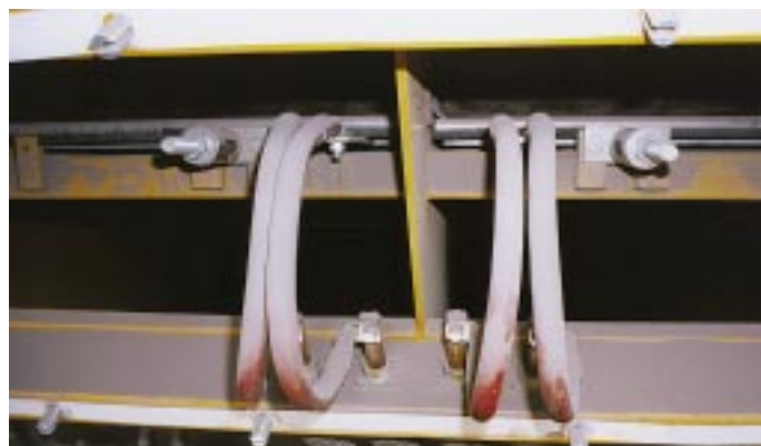
Bild 2: Siebbelagheizung des Mogensen Sizer 2000 Fig. 2: Screen deck heating in the Mogensen Sizer 2000
