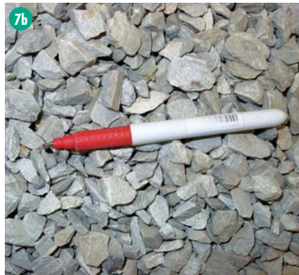
Bild 7 a-c Sortierung von Wollastonit 8–20 mm, Leistung 20 t/h, Abweismenge ca. 40 %
