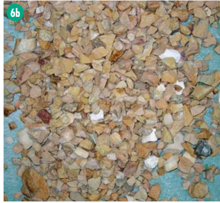
Bild 6 a-c Sortierung von Feldspat 15–40 mm, Leistung: 30 t/h, Abweismenge ca. 40 %
