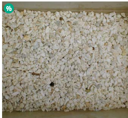
Bild 9 a-c Sortierung von Magnesiumoxid 8–12 mm, Leistung 20 t/h, Abweismenge ca. 40 %
