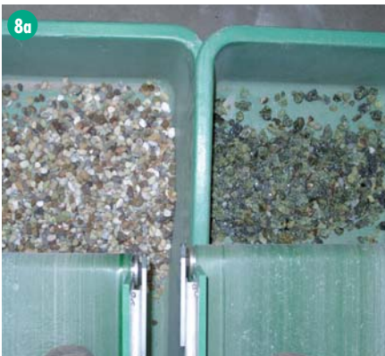
Bild 8 a-c Sortierung von gebranntem Magnesiumoxid 10–30 mm, Leistung: 25 t/h, Abweismenge ca. 30 %
