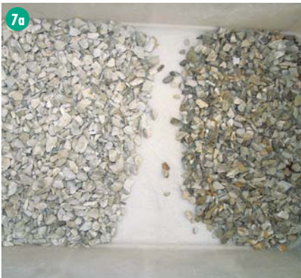
Bild 7 a-c Sortierung von Wollastonit 8–20 mm, Leistung 20 t/h, Abweismenge ca. 40 %
