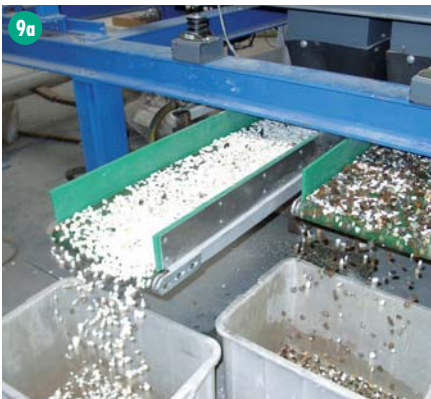
Bild 9 a-c Sortierung von Magnesiumoxid 8–12 mm, Leistung 20 t/h, Abweismenge ca. 40 %
