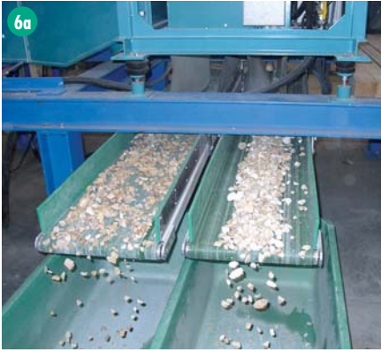
Bild 6 a-c Sortierung von Feldspat 15–40 mm, Leistung: 30 t/h, Abweismenge ca. 40 %
