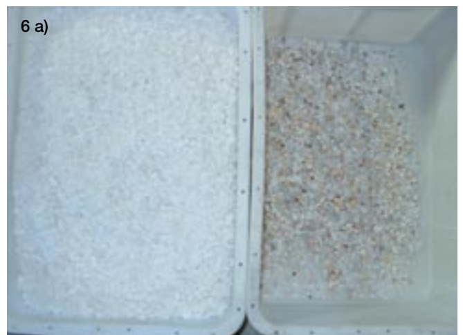
Abb. 6a - c: Sortierung von hochreinen Quarz 3 - 12 mm, Durchsatz 10 t/h, Abweismenge ca. 5 %
