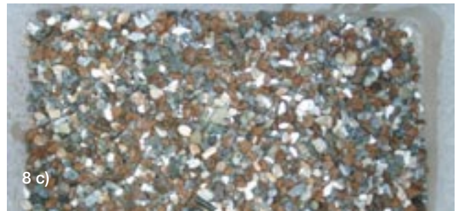
Abb. 8a - c: Sortierung von Magnesiumoxid 8 - 12 mm, Durchsatz 20 t/h, Abweismenge ca. 40 %
