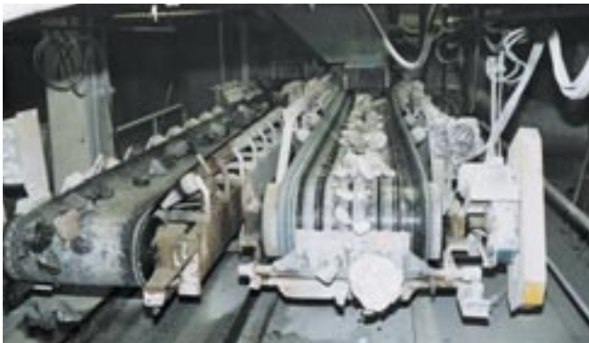
Abb. 7: Sortierung von Kalziumkarbonat 80 - 250 mm, Durchsatz 180 t/h, Abweismenge ca. 40 %
