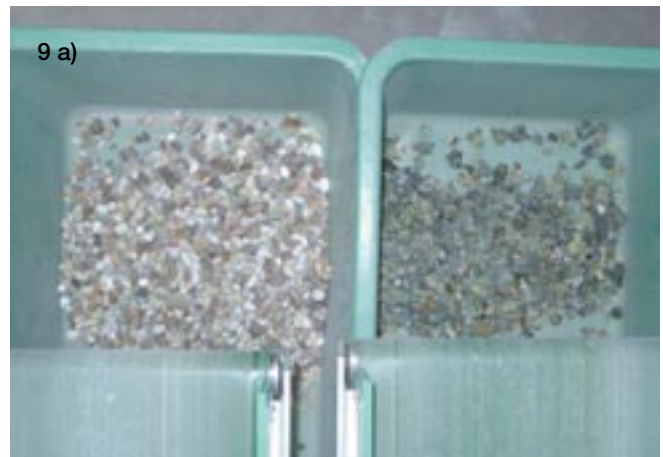
Abb. 9a - c: Sortierung von gebranntem Magnesiumoxid 10 - 30 mm, Durchsatz 25 t/h, Abweismenge ca. 30 %
