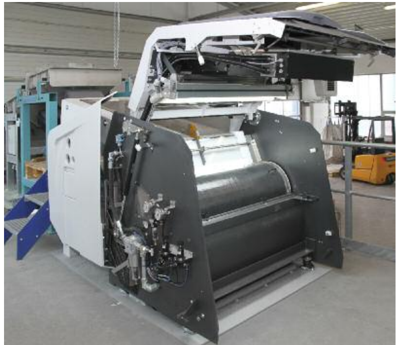
Die neue MSORT Sortiermaschine im praxisorientierten Design mit geöffneten Serviceklappen
