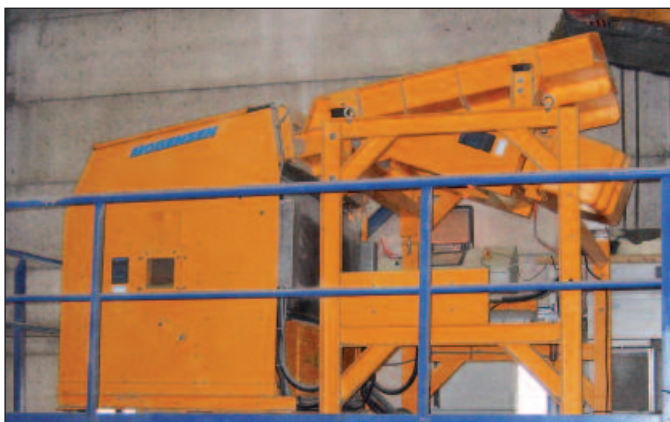
← 3,5 m → Das Mogensen Röntgensortiergerät Typ AQ 1101 im Einsatz
